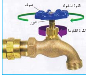
الشكل (٦-٦) : كيفية عمل المحور والعجلة
